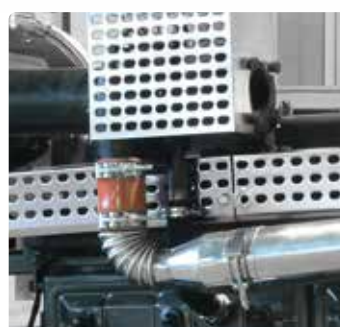
Защитные решетки на горячих деталях двигателя
